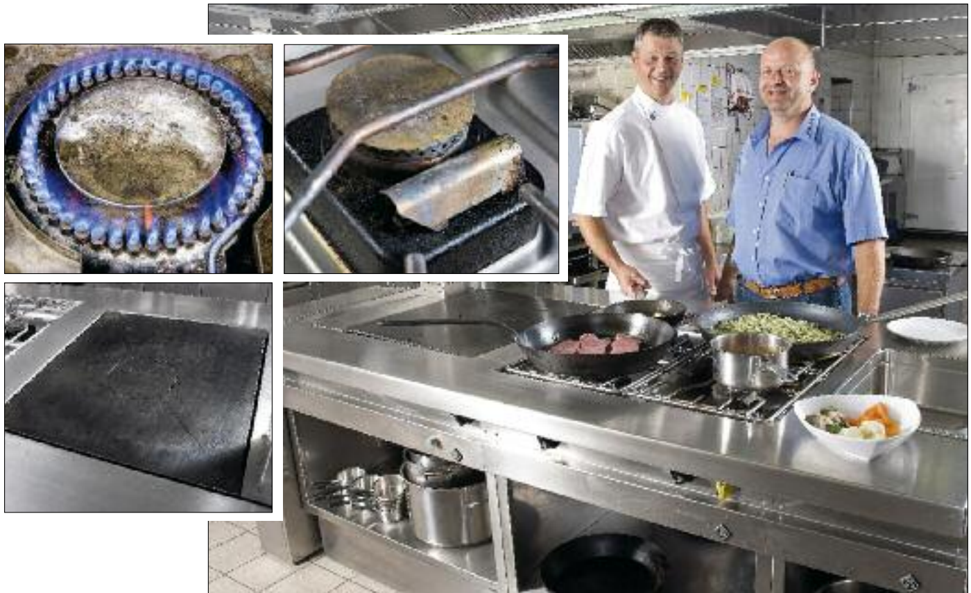
Gilden-Restaurateur Daniel Bader und Küchentechnik-Spezialist Toni Büchler am MKN-Gasherd im «Gasthof zum Kreuz» in Holderbank. Interessante Features im MKN-Gasherd «Optima 850 Meister»: Offene Gaskochstelle mit Pilotflamme und Zündsicherung, gasbeheizte Glühplatte für die A la Carte-Pfännchen.
